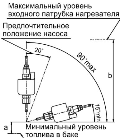
a – высота забора топлива до 700мм;
