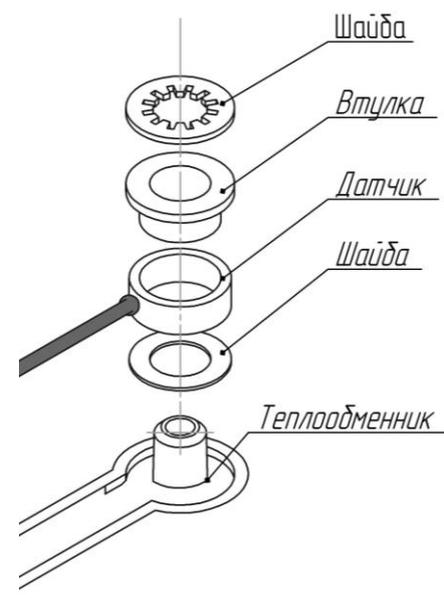
Рис.8 – Датчик перегрева (термопара)
