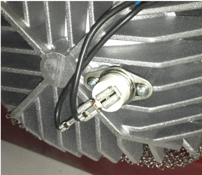
Рис.7 – Датчик перегрева
