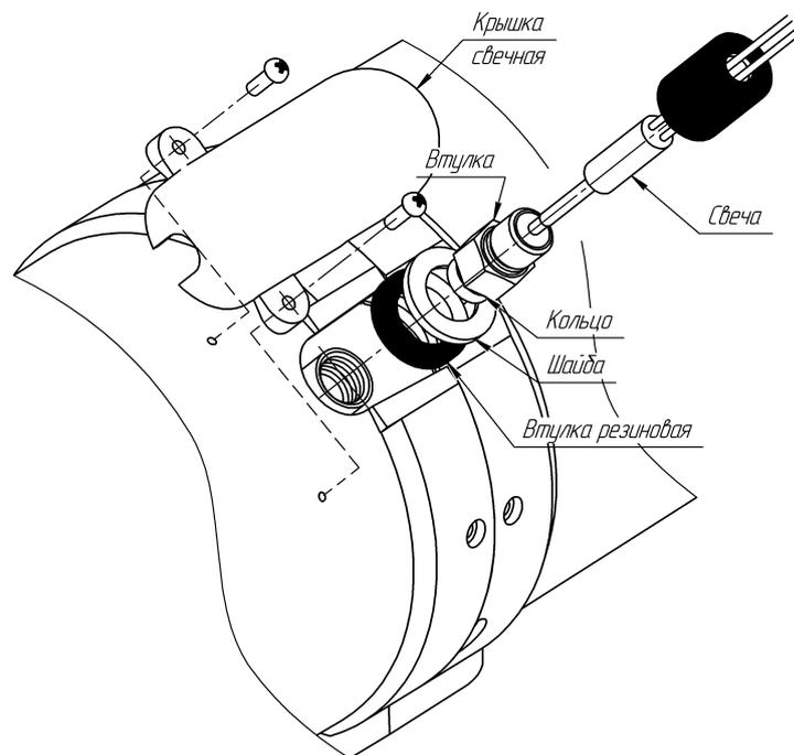
Рис.4 – Свеча с монтажным комплектом.
