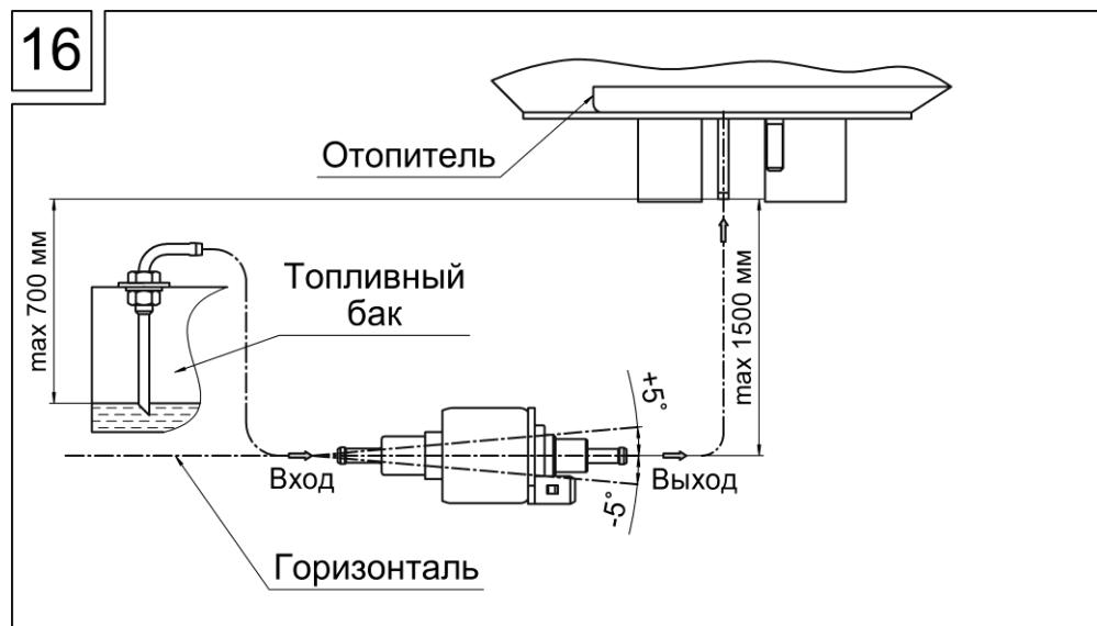
Для стабильной работы отопителя необходимо устанавливать топливный насос не далее, чем на 1000 мм от топливного бака и ниже нижнего уровня в топливном баке, как показано на рисунке 16.
