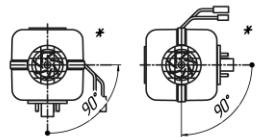
Расположение топливной трубы при боковом монтаже отопителя только в верхнем положении
