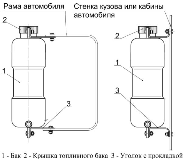
Топливный бак устанавливается на транспортное средство таким образом, чтобы он и его пробка в закрытом положении не выступали за габариты транспортного средства.
