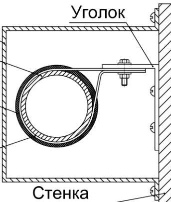
Категорически запрещается монтаж отопителя с открытым участком выхлопной трубы внутри фургона, изотермического фургона, КУНГа и других помещениях транспортного средства, в случае установки отопителя на подвесной кронштейн, как показано на рисунке 28.
